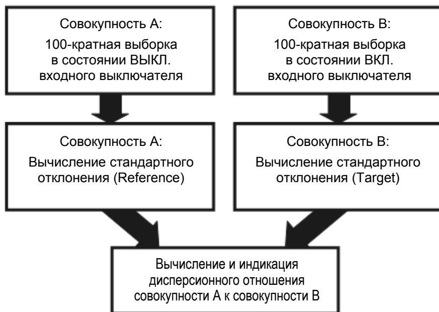
Рис. 5-15 Функциональная схема проверки уровня шума
